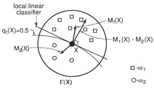
Fig. 11-11 The gradient of  $q_1(X)$ .
